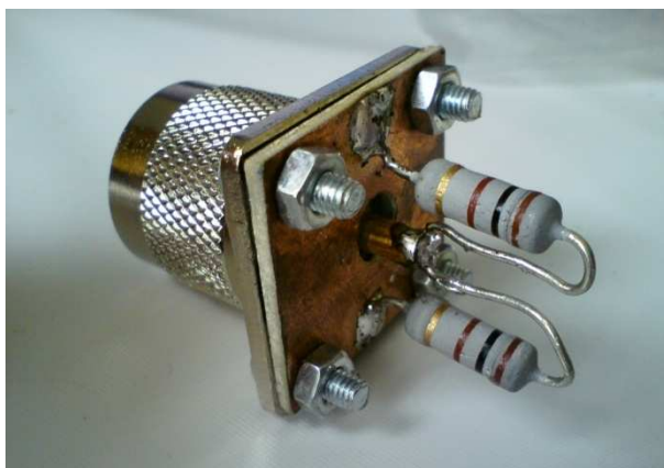
Obr. 3.7: 50 \Omega umělá zátěž ( P_{\max} = 4 \text{ W} )
