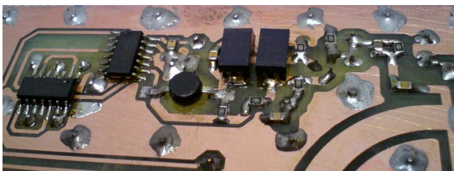
Obr. 3.5: Realizace čítače na desce plošných spojů
