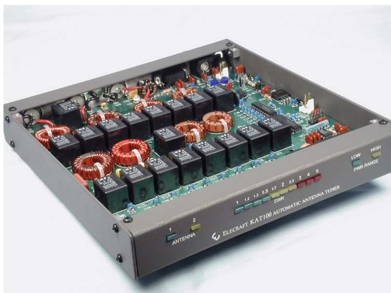
Obr. 3.2: Automatický anténní tuner Elecraft KAT100 bez horního krytu (převzato z [6]).
